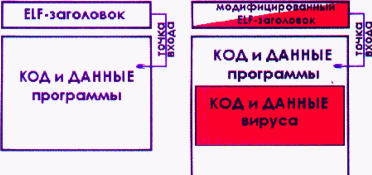
Рисунок 7. Типовая схема заражения исполняемого файла путем расширения его кодовой секции
